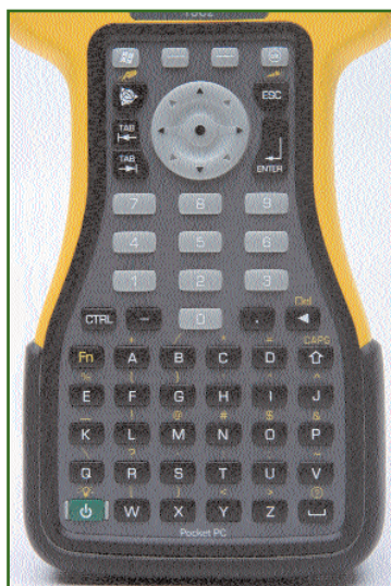
Рис. 4 Клавиатура контроллера TSC2
